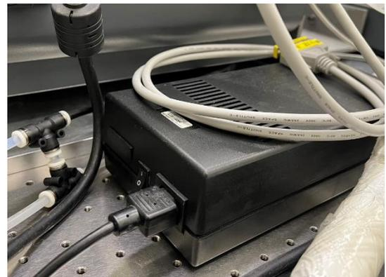
2. Thermo NICOLET 6700 機台後方 **Accessory ( ← )** 15 pin 線連接至積分球套件
